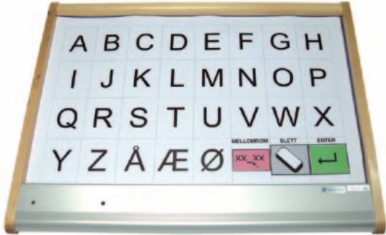
FLEXIBOARD MED FLEXIKOM • Art. nr: 720360 FlexiKom inneholder FlexiBoard samt programmene FlexiLader , FlexiWord med talesyntese og FlexiView .
